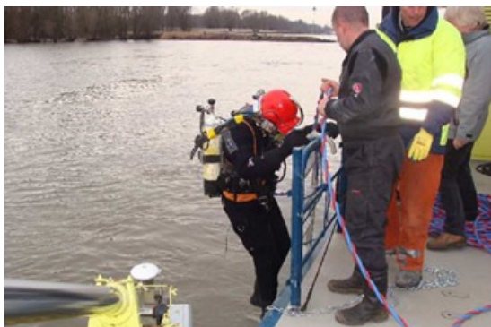
Installatie van een Cera-Diver in een meetpunt voor oppervlaktewater (bron: Rijkswaterstaat)
