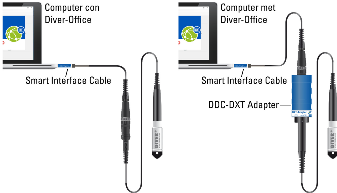
Figura 3 Smart Interface Cable conectado a (izquierda) un DXT-cable y (derecha) a un cable de datos Diver a través del adaptador DDC-DXT Adapter (AS348).
